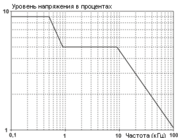
Рис. 47. Допустимые уровни управляющих сигналов.
